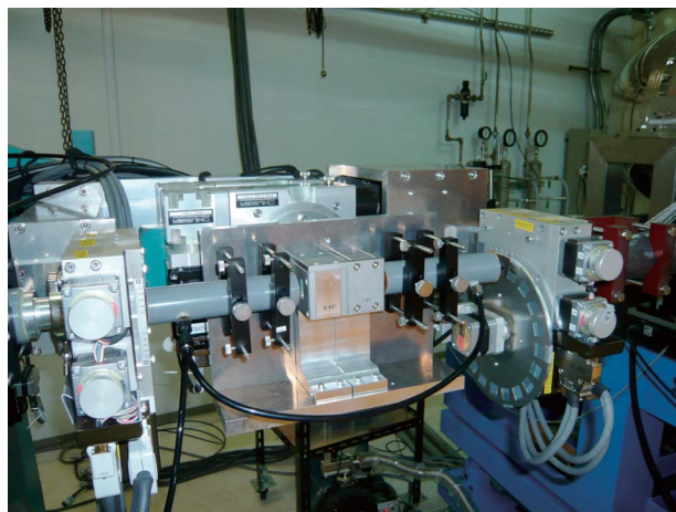
図4 多軸回折計の検出器アームに設置した小型ソーラースリット
