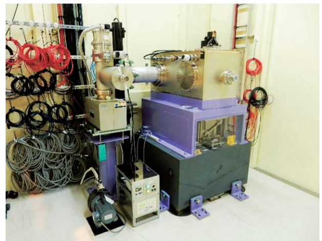
図5 BL19LXUの実験ハッチ3に常設されたKB集光装置。簡便に20ミクロン程度の安定した集光ビームを利用できる。
