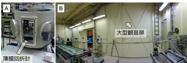
図2 FSBLの設備。(A) 第一ハッチ内の試料水平配置型薄膜回折計、(B) 第二ハッチの実験スペースと大型観音屏
