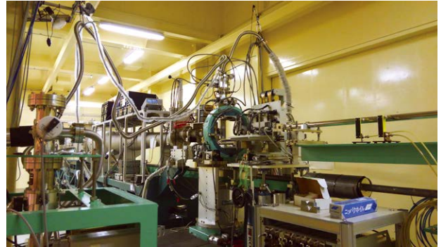
図1 BL35XUで2 Kクライオスタットの使用状況。手前左に見えるポンプの後ろにヘリウムガス精製装置が、写真中央の非弾性散乱分光器の奥に冷凍器用のコンプレッサーが配置されている。
