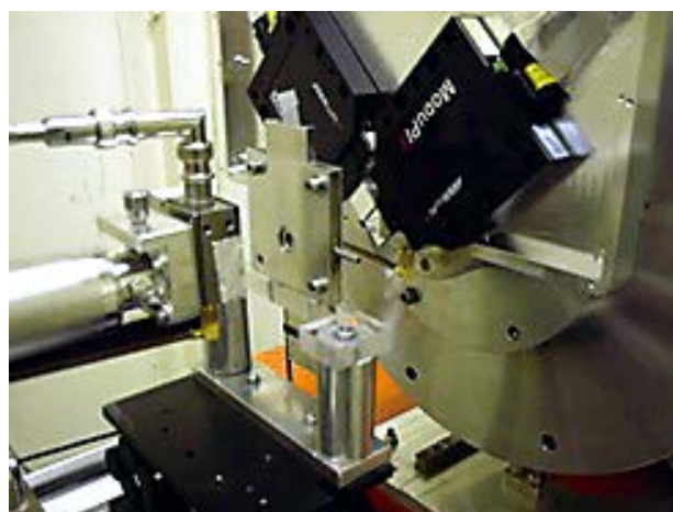
図1 広角用X線検出器としてMODUPIXを2台配置
