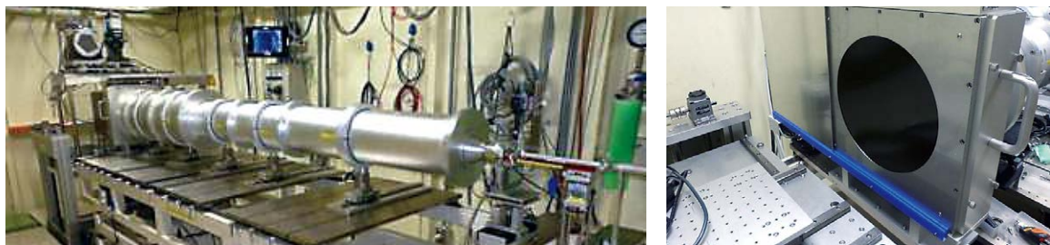
図4 大口径真空パイプ
