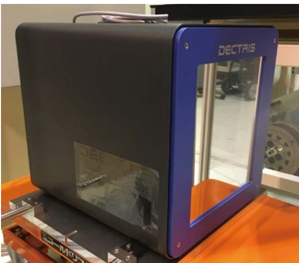
図1 更新により導入した大型2次元ピクセル検出器 PILATUS3 X 2M
