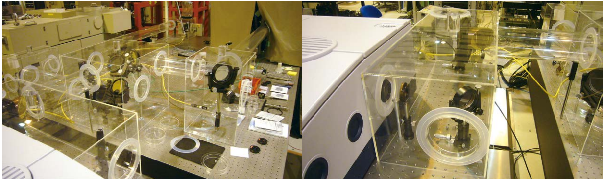
図3 (左) 改造した入射光学系、(右) 分光装置入射ミラーは平面鏡で、その上流に放物面鏡を設置した。
