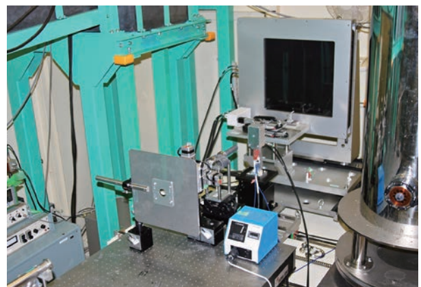
図1 大面積2次元検出器を利用した時分割PDF解析装置のセットアップ
