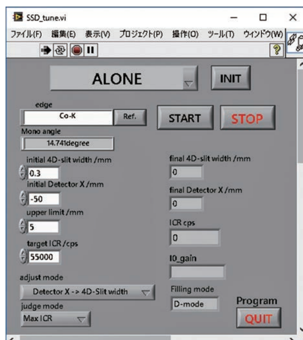
図1 19素子SSDと試料間の距離および4象限スリット開口幅の自動調整プログラムGUI
