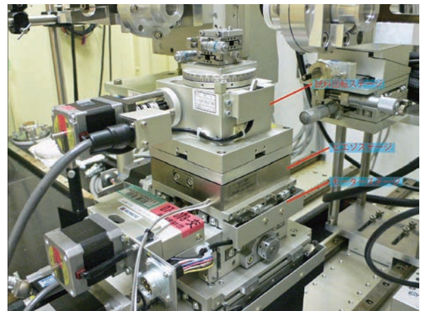
図1 走査結像型X線CT装置の試料部
