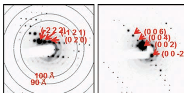
図5 イネ萎縮ウイルス結晶 (I222, a=768.9, b=794.7, c=810.4 Å) からの超高分解能データ収集 ( \lambda=1.9 Å)
