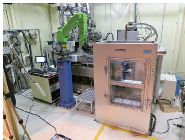
図1 BL26B1実験ハッチ内のプレートスキャン・自動交換装置 プレート交換用6軸ロボットおよび54プレート保管可能な 恒温槽
