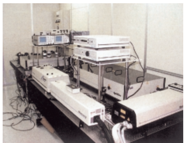
放射光パルス同期チタンサファイアレーザーシステム（BL29XU）。X線パルスとレーザーパルスを2ピコ秒以下の精度で同期させ、ポンププローブ実験等様々な用途に用いられる。
